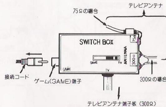
●アンテナ切換えスイッチの取付けかた
