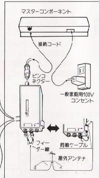
④75Ω、300Ω切換えのあるものは必ず300Ωに切換
